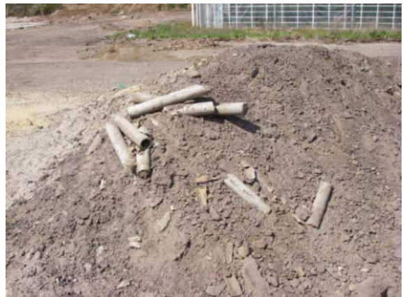
AC-buizen nabij proefsleuf 24
