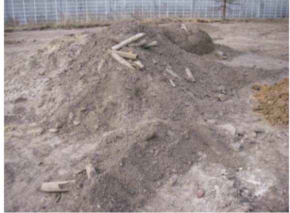
Asbestverdacht materiaal naast ASB07
